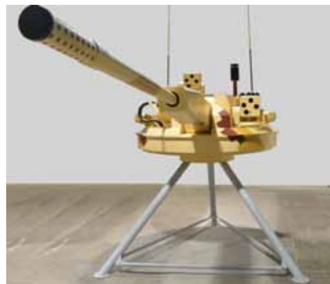
Боевой модуль с артиллерийской установкой АУ 220М
