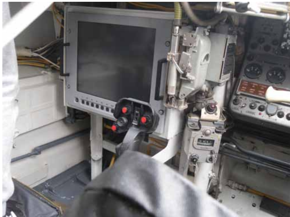
Рабочее место командира в модернизированной БМП-3 «Деривация»
